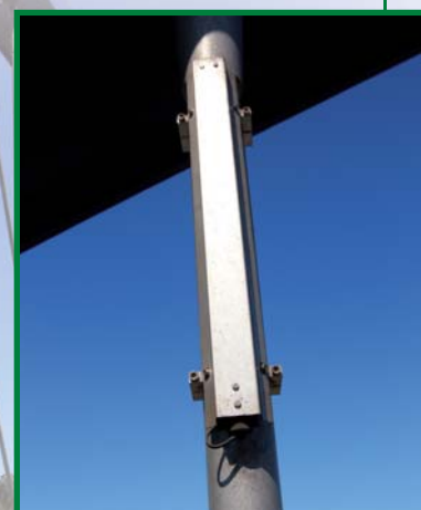
snímač je opatřen krytem z korozi-vzdorné oceli
