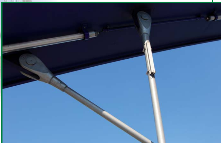
nainstalovaný induktivní dynamometr INDY
