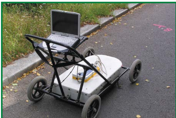
georadar nad kanalizační stokou
