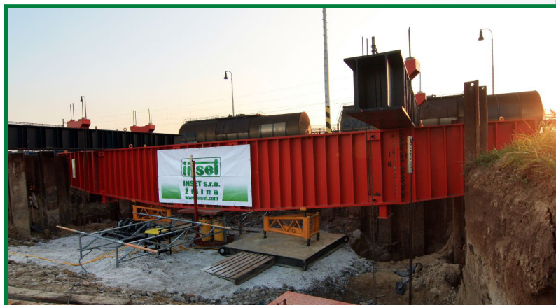
zatěžovací konstrukce pro max. sílu 5000 kN ukotvená do kotevních pilot pomocí lan
