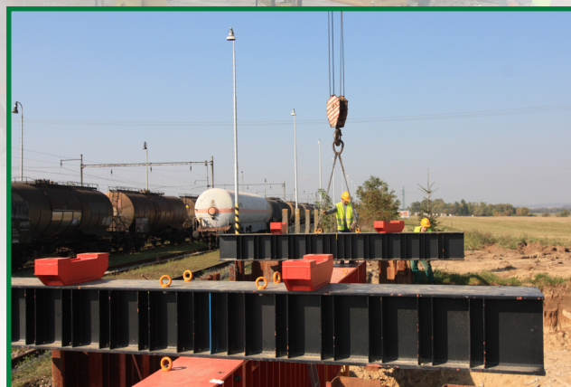
zatěžovací konstrukce pro max. sílu 5000 kN ukotvená do kotevních pilot pomocí lan
